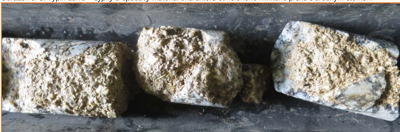
Obrázek č. 3: Výplň zdiva – sypký a opadavý materiál charakteru stmeleného hlinitého písku s drobným štěrkem
