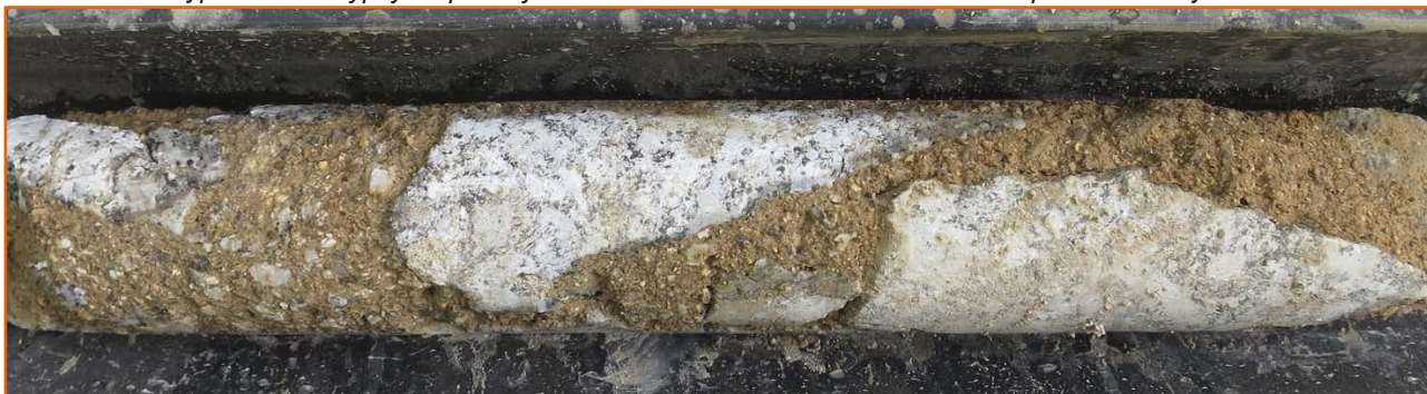
Obrázek č. 7: Výplň zdiva – sypký a opadavý materiál charakteru stmeleného hlinitého písku s drobným štěrkem
